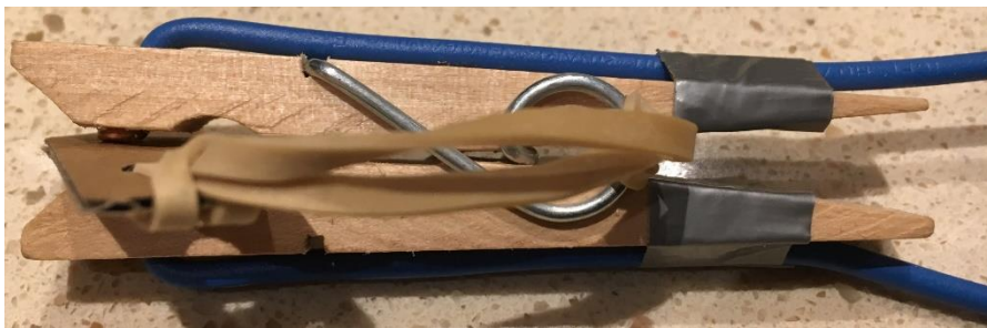
Eksempel på tøjklamme kontakt i afbrudt og sluttet stilling
